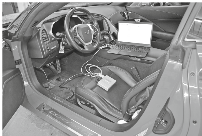
Abbildung 1: Bosch CDR Interface im Einsatz, angeschlossen über die OBD2-Schnittstelle
