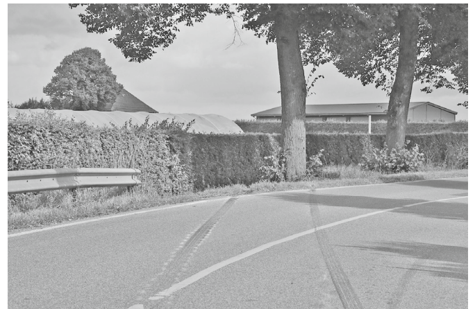
Abbildung 3: Bremsblockierspuren, wie sie früher üblich waren ( https://commons.wikimedia.org )
